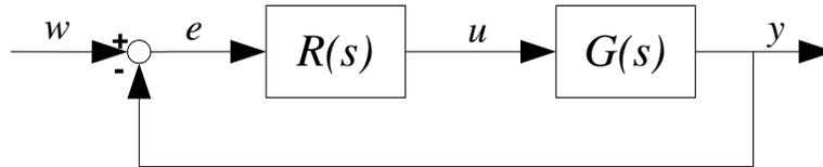
Figura 1: Il sistema di controllo
