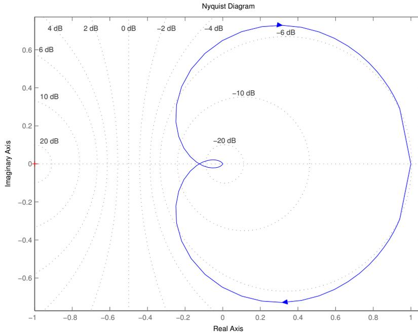
Figura 3: Diagramma di Nyquist di  $L(s)$  (con  $R(s) = 1$ )
