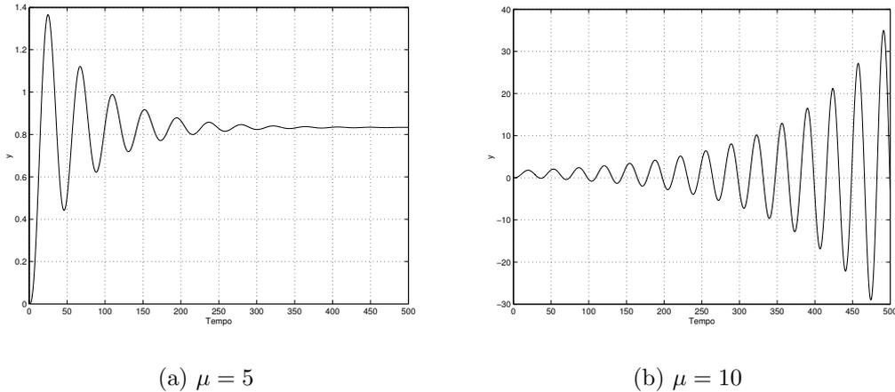
Figura 2: Risposte allo scalino con regolatore proporzionale
