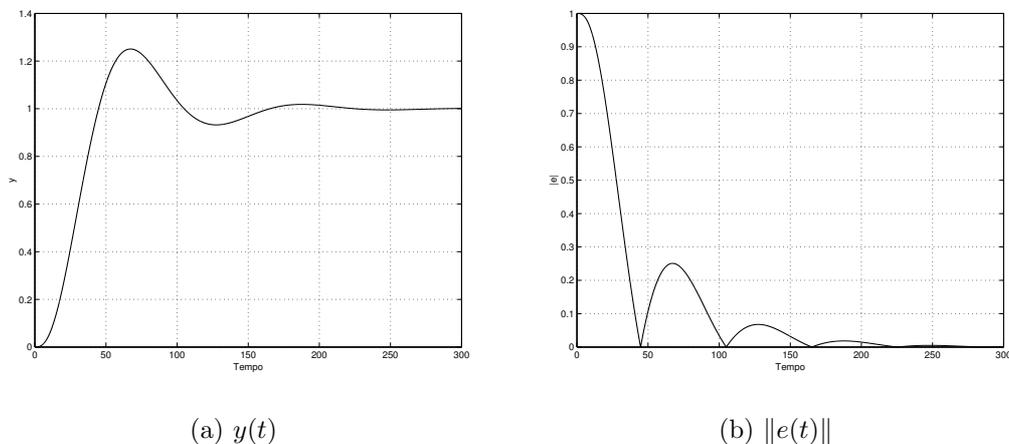
Figura 5: Risposta allo scalino con controllore proporzionale-integrale
