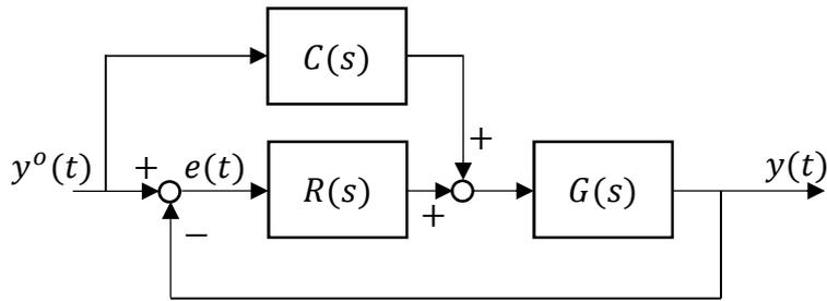
4.1) Ricavare la funzione di trasferimento d'anello, assumendo  $R(s) = 10$  e  $G(s) = \frac{200}{(s+2)(s+100)}$ .
